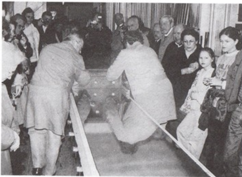
Das Gießen der Zinnbleche für die Pfeifen
